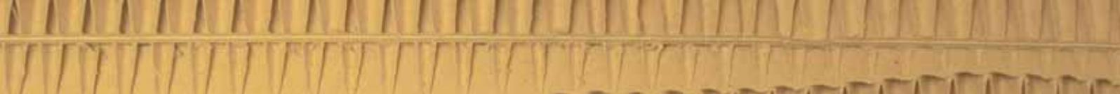
X-Board di XANITA è un pannello-sandwich di nuova generazione, totalmente eco-friendly, composto di fibra di carta riciclata al 100%, formato da due fogli di carta stampabile e da una struttura a nido d'ape, incollati tra loro con una colla organica eco-compatibile, dotato di un alto rapporto resistenza/peso, adatto per usi interni.
